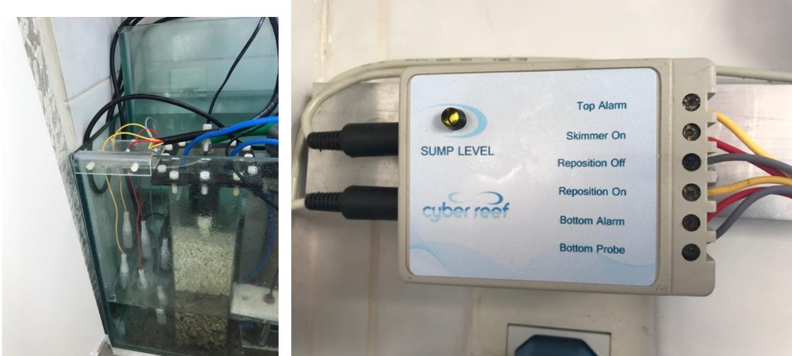
**Bottom Probe** – Este eletrodo emite sinais elétricos para os demais eletrodos, por **esse** motivo ele deve estar sempre imerso no sump (Eletrodo de Fundo).
