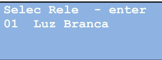
Utilize as teclas **UP** e **Down** para navegar entre os relés 1 e 8. Devemos pressionar **<enter>** para selecionar o Relé que desejamos modificar a função de controle ou **<menu>** para sair da opção e voltar ao Menu. Quando escolhemos modificar o controle, a seguinte tela é exibida solicitando a nova função para o relé.
