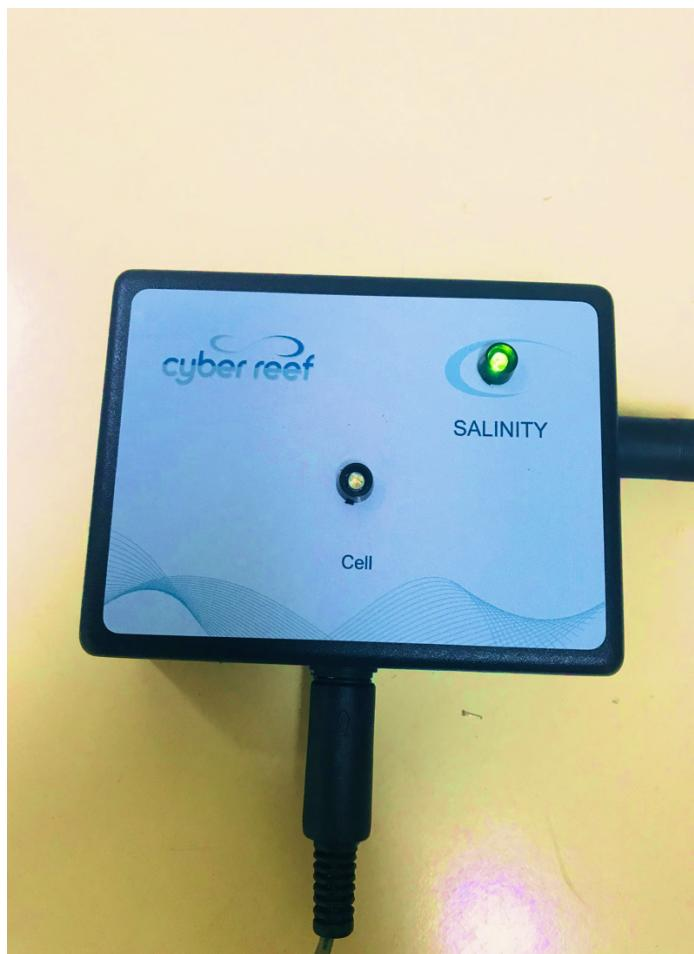
Posicione a unidade com parafusos ou cola, conecte a unidade no barramento com o cabo fornecido (Mini Dim 6 Pinos), e conecte o sensor de condutividade (Mini Din 4). Posicione o eletrodo com a ponta inserida na água, em caso de flutuação use a placa de isopor conforme descrito anteriormente. Será necessária a instalação lógica desta unidade na opção 21 no item (salt).
